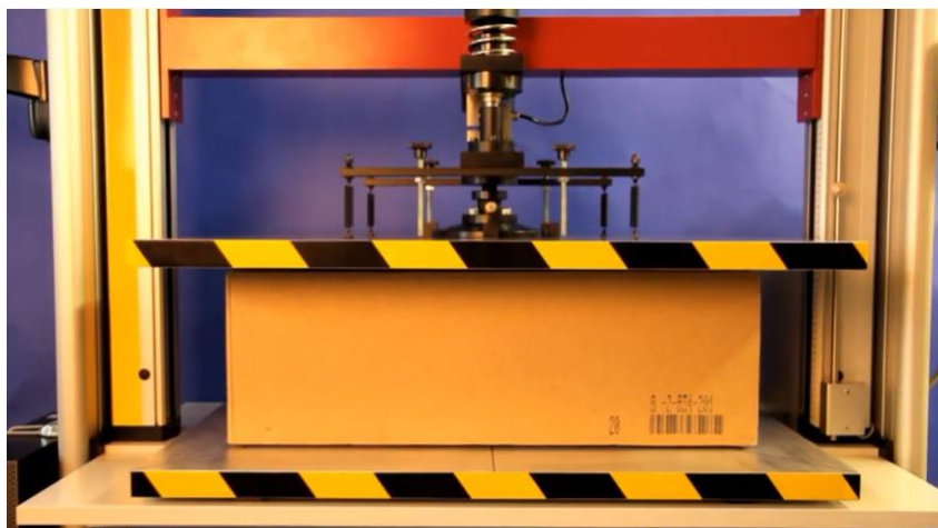
ภาพที่ 2.4 การทดสอบความสามารถในการรับแรงกดกลองลูกฟูกในแนวตั้ง ที่มา: https://www.youtube.com/watch?v=GRTJEM_oWbQ สืบค้นเมื่อ 1 มีนาคม 2565.
